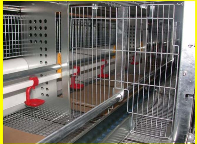
Die gesamte Anlage wird aus verzinktem Material in Specht-Qualität, in einer stabilen und robusten Ausführung hergestellt. In den einzelnen Etagen sind Kotbänder (PP-Bändern) vorgesehen die von den herkömmlichen Stirnteilen, wie in der Batterie angetrieben und geleitet werden, so dass eine erste Entmistung erst nach ca. 10 Tagen erforderlich ist, und dann später etwa einmal die Woche, je nach Länge der Anlage.
